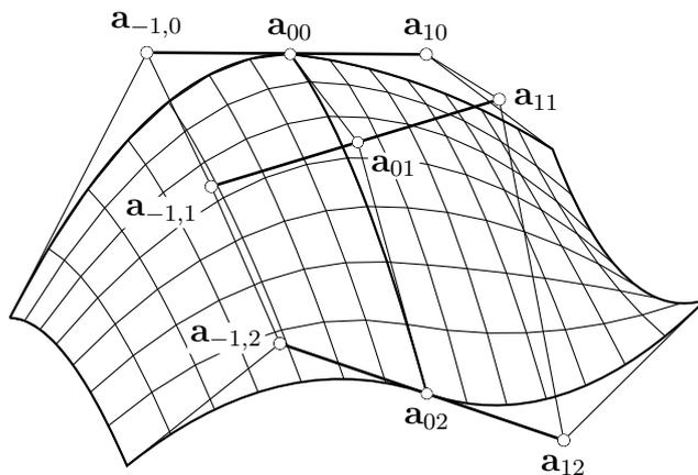
Рис. 5. Сшивка поверхностей Бэзе по общему ребру
