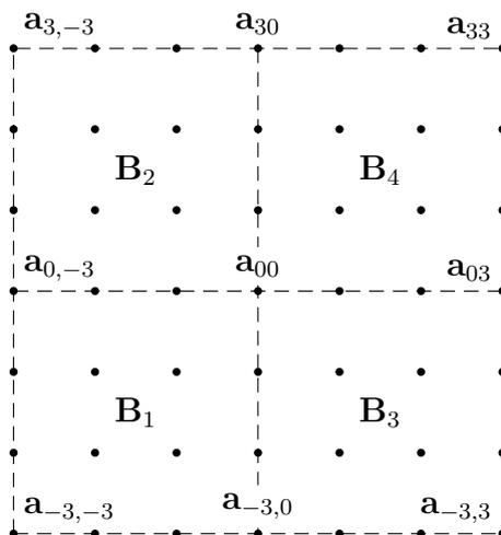
Рис. 6. Сшивка четырёх порций  $\mathbf{B}_i(u, v)$ ,  $i = 1, \dots, 4$
