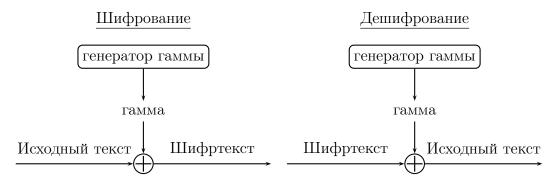
Стандартно секретный ключ размножается до гаммы с помощью устройств, называемых регистрами сдвига с линейной обратной связью (Linear Feedback Shift Register, сокращённо LFSR).
